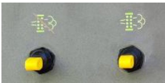
5-17. ábra DPF regenerálási tiltó gomb és regenerálási gomb
