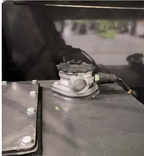
5-4. ábra Hidraulikus visszatérő szűrő
