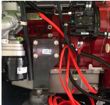
5-19. ábra Motor elektromos fűtése (opcionális)
