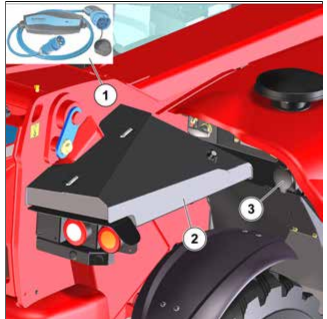
Ábra 76: A nagyfeszültségű akkumulátorok és a 12 V-os akkumulátor töltése
