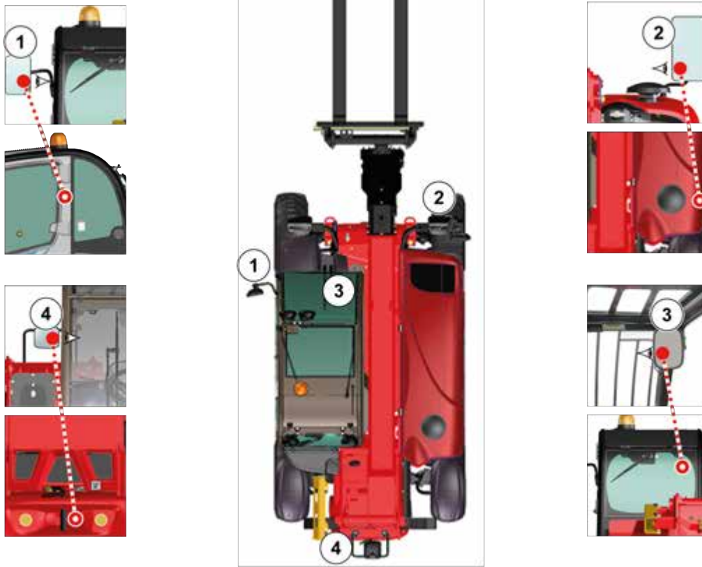
Ábra 73: Referenciapontok a tükör beállításához
