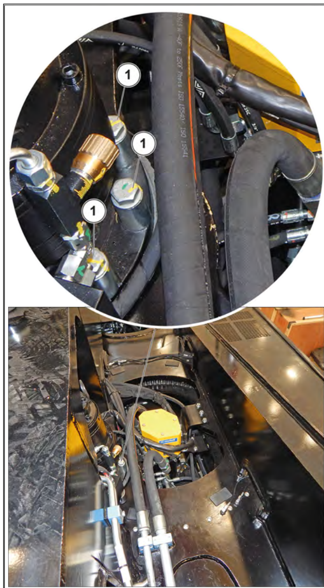
Ábra 255: Forgásreduktor rögzítőcsavar meghúzásának ellenőrzése
