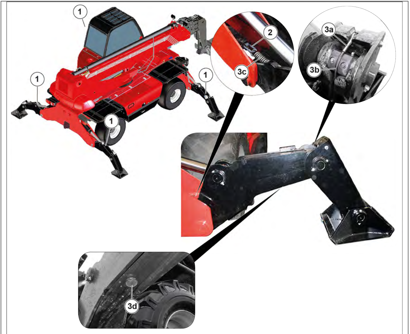
Ábra 288: A belső stabilizátor alkatrészeinek cseréje
