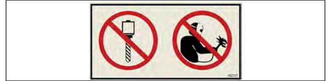
Ábra 50: Matrica - Figyelmeztetés ROPS/FOPS felszerelve, ne fúrjon vagy hegesszen
