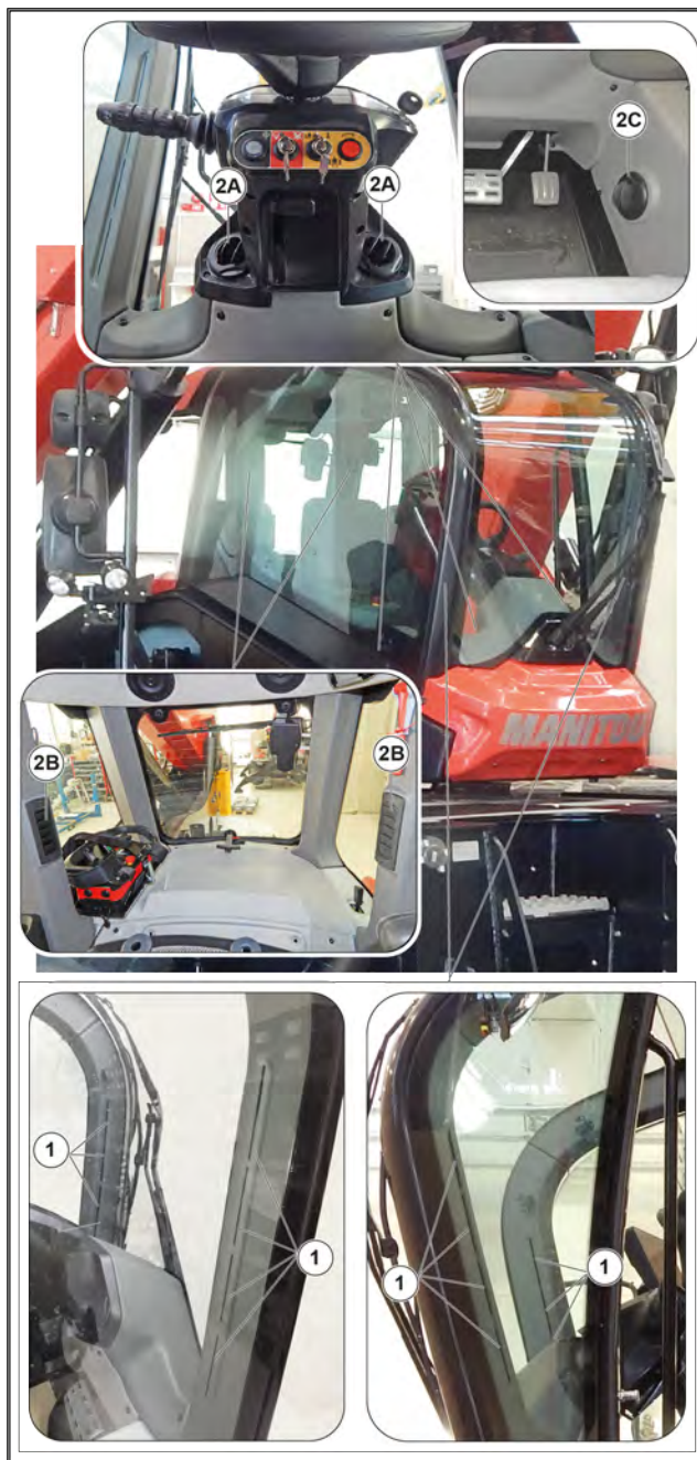
Ábra 103: Páramentesítő diffúzorok és fűtési levegőnyílások
