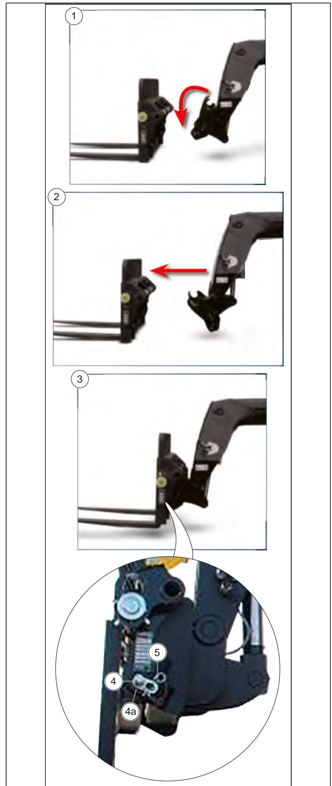
Ábra 211: A munkaszerelek manuális blokkolással történő visszaszerelése
