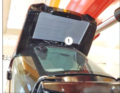
Ábra 1: A kondenzátor hűtőrácsának ellenőrzése és tisztítása
