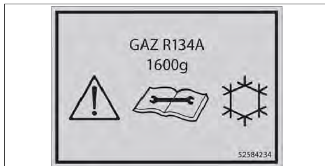
Ábra 54: Légkondicionáló rendszer feltöltése
