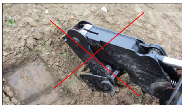
Ábra 224: Ellenőrizze a stabilizátorok megfelelő nyitását vagy kinyújtását.
