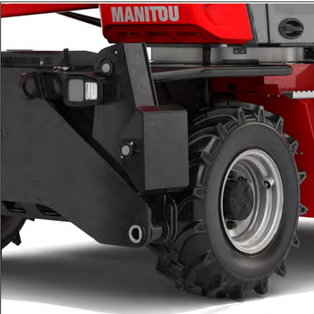
Ábra 226: Közúti forgalom - A stabilizátorok teljesen zárva (MRT 2145 – MRT 2545)
