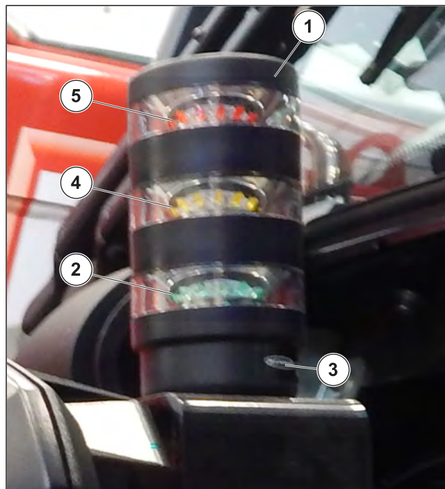
Ábra 187: Jelzőoszlopok a terhelési állapot ellenőrzésére.
