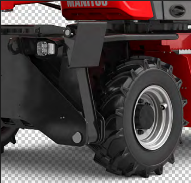
Ábra 225: Közúti forgalom - A stabilizátorok teljesen zárva (MRT 1645 – MRT 1845)
