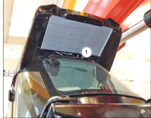
Ábra 1: A kondenzátor hűtőrácsának ellenőrzése és tisztítása
