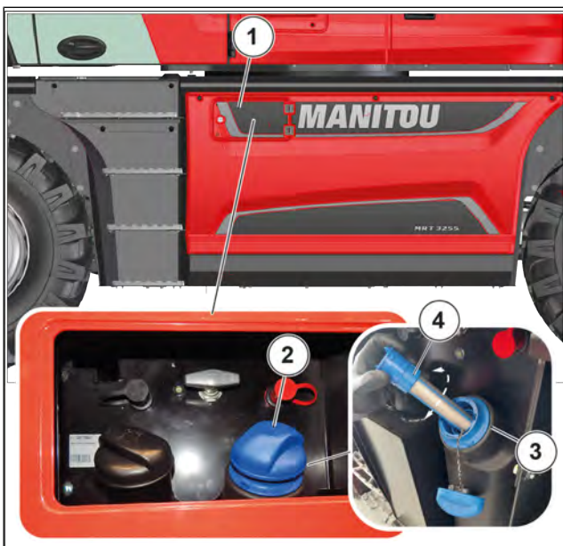
Figure 308: A DEF tartálytöltő szűrő ellenőrzése és tisztítása
