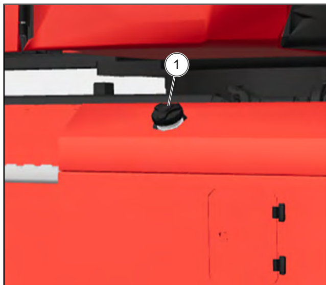
Ábra 208: Az üzemanyagtartály feltöltése
