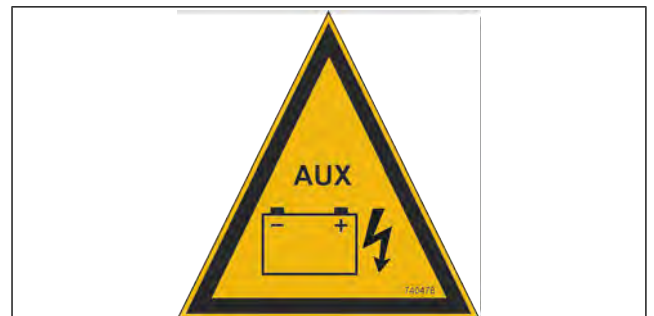
Ábra 51: Matrica - Indítás külső akkumulátorról (jármű)
