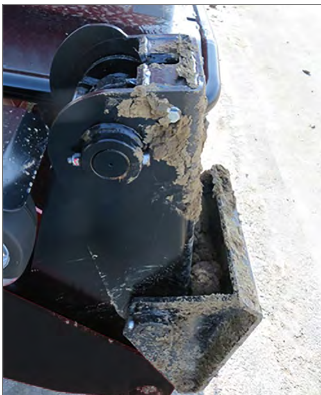
Ábra 222: Törmelék és szennyeződés eltávolítása a stabilizátorokról.
