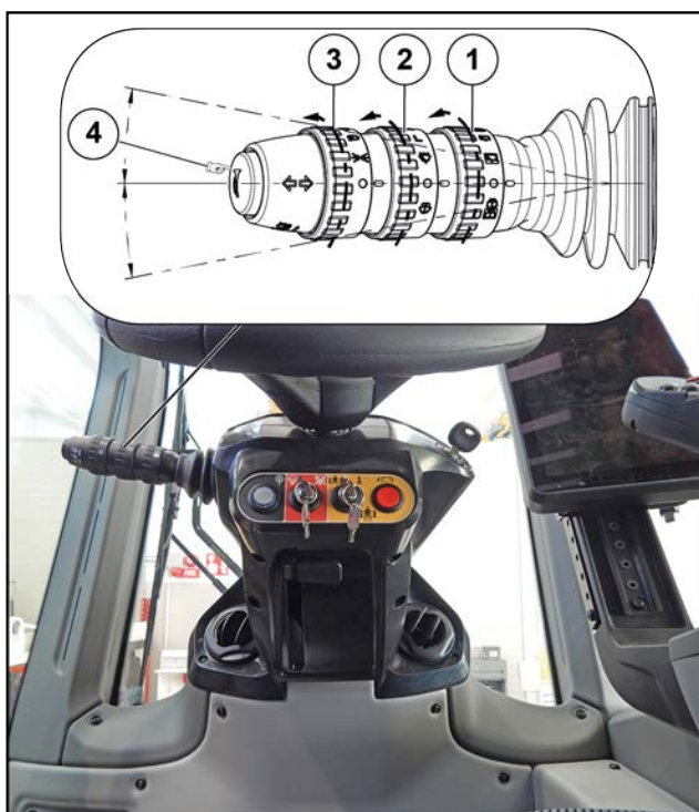
Ábra 52: Vezérlőkar lámpákhoz, kürtökhöz, jelzőlámpákhoz és ablaktörőkhöz
