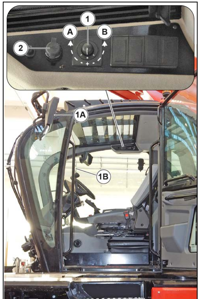
Ábra 116: Külső oldalsó visszapillantó tükrök vezérlője és USB-port
