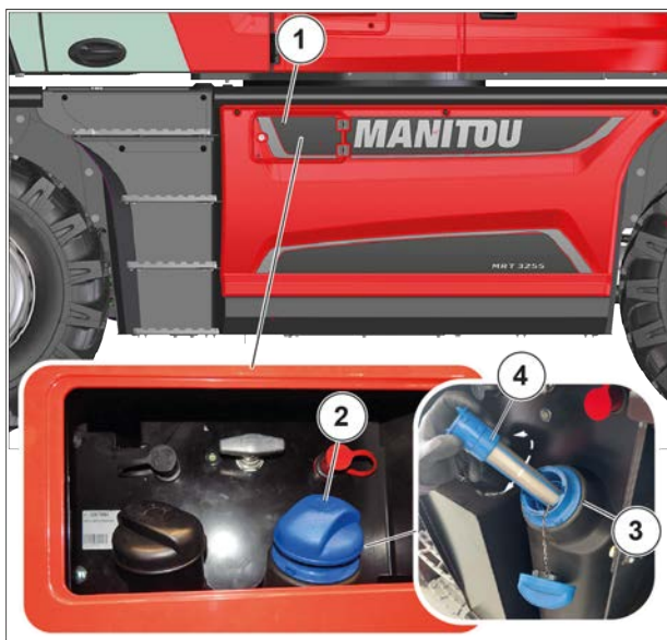
Figure 209: A DEF tartálytöltő szűrő ellenőrzése és tisztítása
