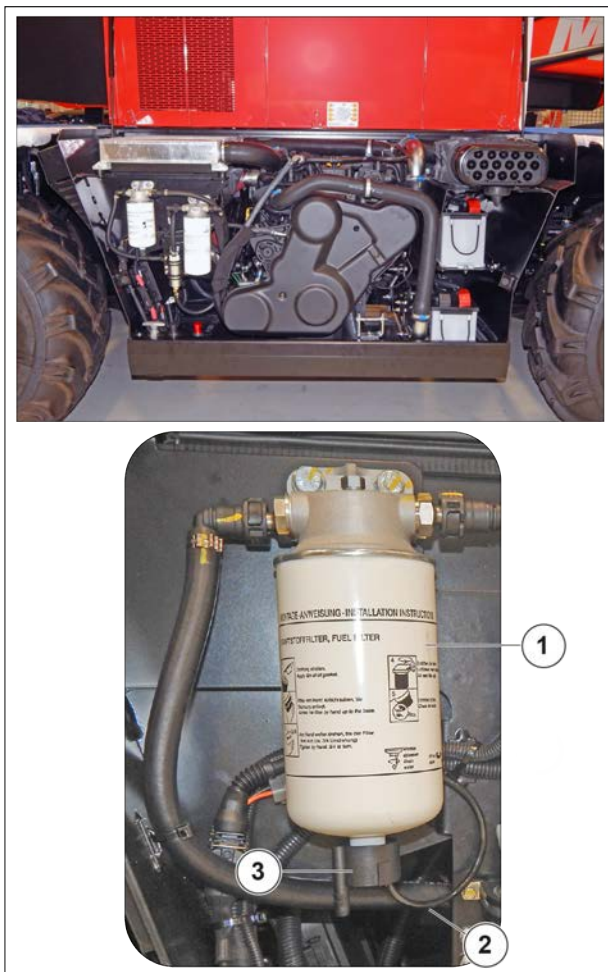
Ábra 144: Üzemanyag előszűrő ellenőrzése
