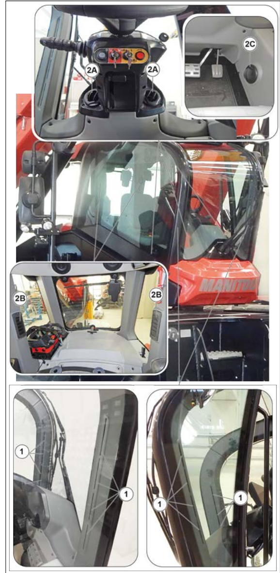
Ábra 61: Páramentesítő diffúzorok és fűtési levegőnyílások
