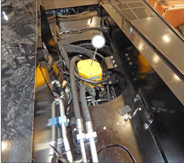
Ábra 208: A forgó elektromos kollektor távadó gyűrűinek ellenőrzése és tisztítása
