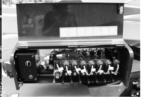
61. ábra A talajon lévő rész hidraulikus vezérlődoboza
