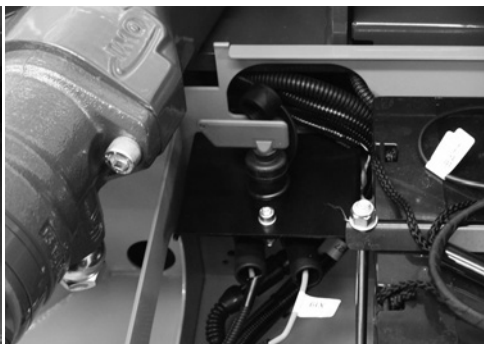
8. ábra Az akkumulátor leválasztó kapcsolója, lítium változat
