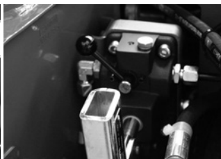
67. ábra Kéziszivattyú hidraulikus leeresztőcsatornája
