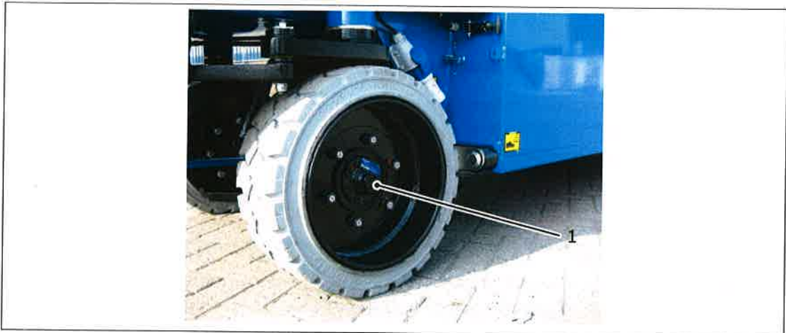
Ábra 33: többtárcsás fék rögzítő csavarja
