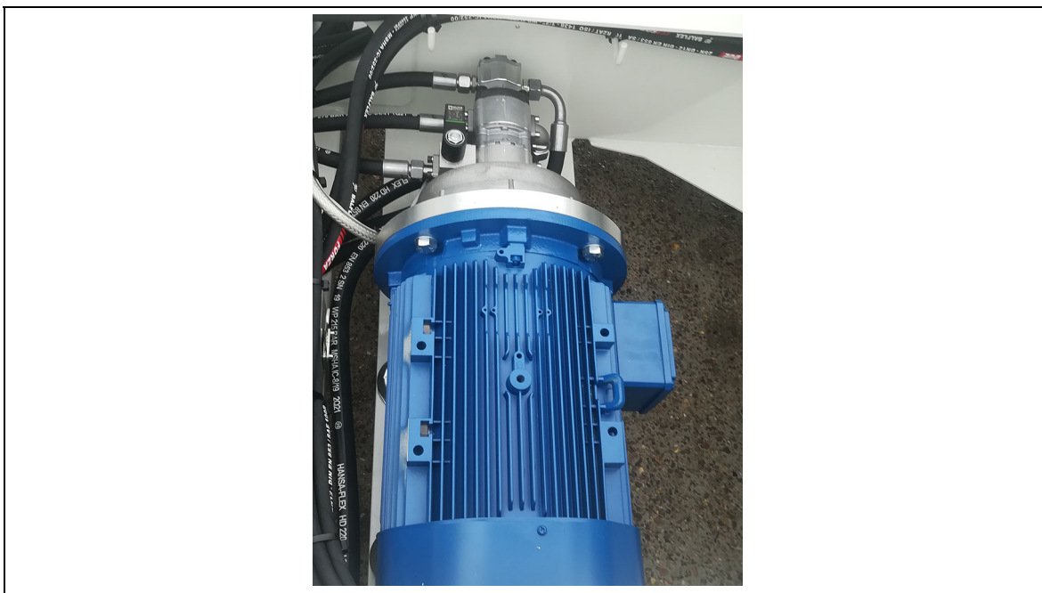
Ábra 32: 400 V-os váltóáramú szivattyúmotor
