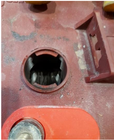
Megfelelő elektrolit szint
