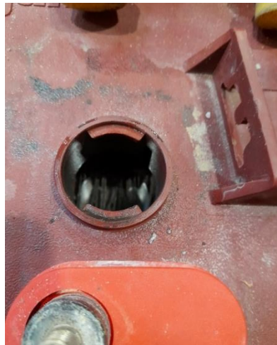
Cellák tetejét eléri az elektrolit, de elektromosan feltöltött állapotban ez alacsony!
