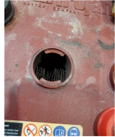
Kiszáradt akkumulátor, csere szükséges
