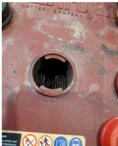
Száraz akkumulátor, csere szükséges
