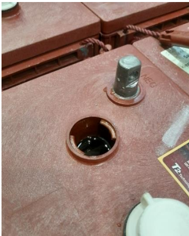
Az akkumulátor túl van töltve
