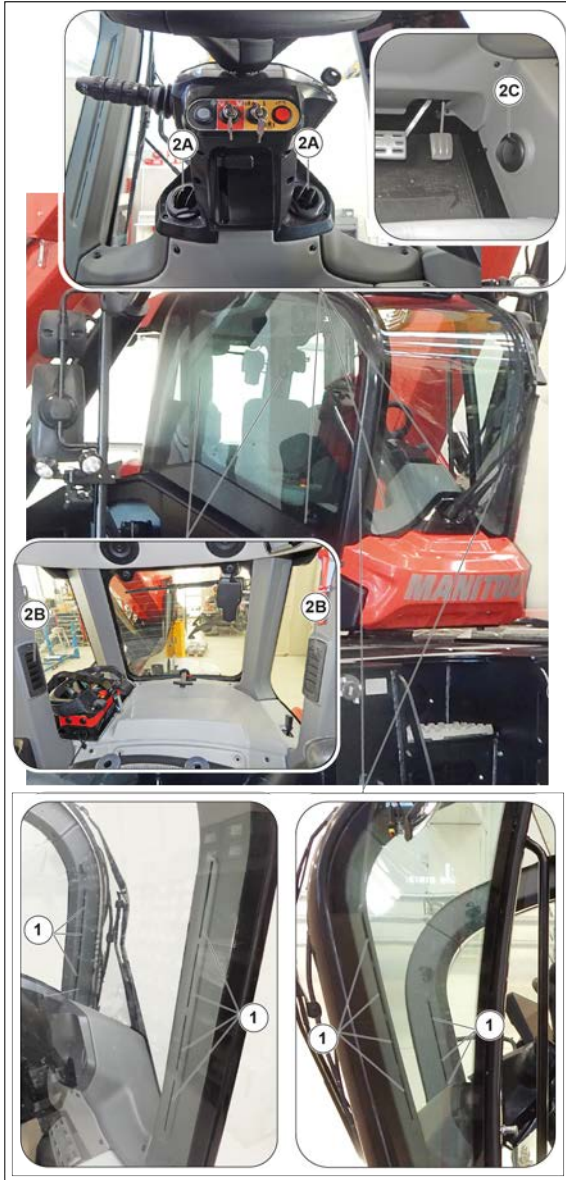
Ábra 62: Páramentesítő diffúzorok és fűtési levegőnyílások
