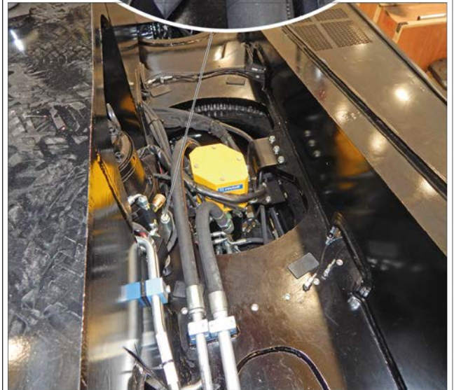
Ábra 166: Forgásreduktor rögzítőcsavar meghúzásának ellenőrzése
