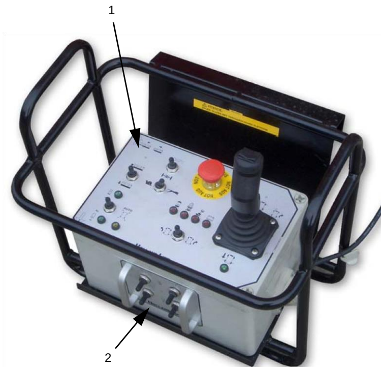
Egy vezérlőegység a két vezérlőpanellel (4WDS(N))
