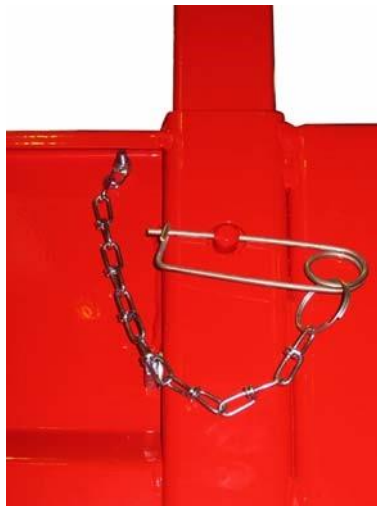
Az emelőkosár védőkorlátszakaszának rögzítő csapja
