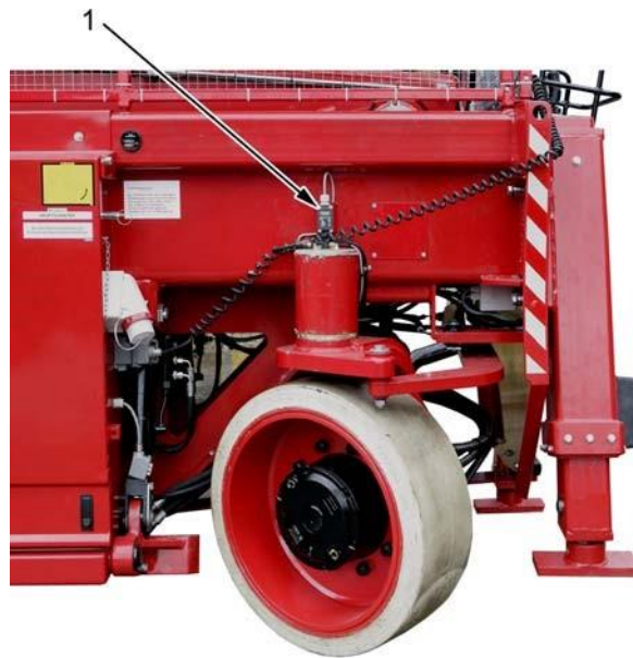
A hátsó kerekek pozíciójának érzékelése
