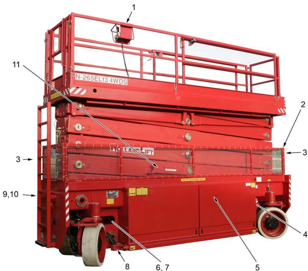
A biztonsági berendezések elhelyezkedése az ollós emelőgépen
