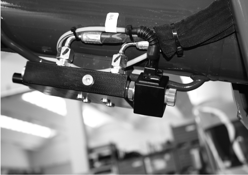
Fig. 81 Elektromos szelep a vészhelyzeti gravitációs ereszkedéshez
