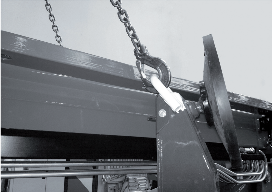
Fig. 189 Emelési pontok kötéllal vagy láncokkal
