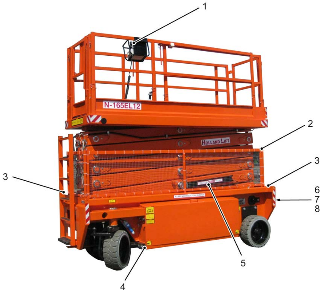
A biztonsági berendezéseinek elhelyezkedése az ollós emelőn
